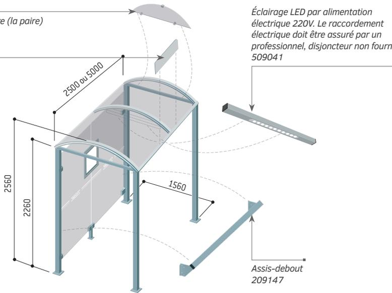
Éclairage LED par alimentation électrique 220V. Le raccordement électrique doit être assuré par un professionnel, disjoncteur non fourni 509041
