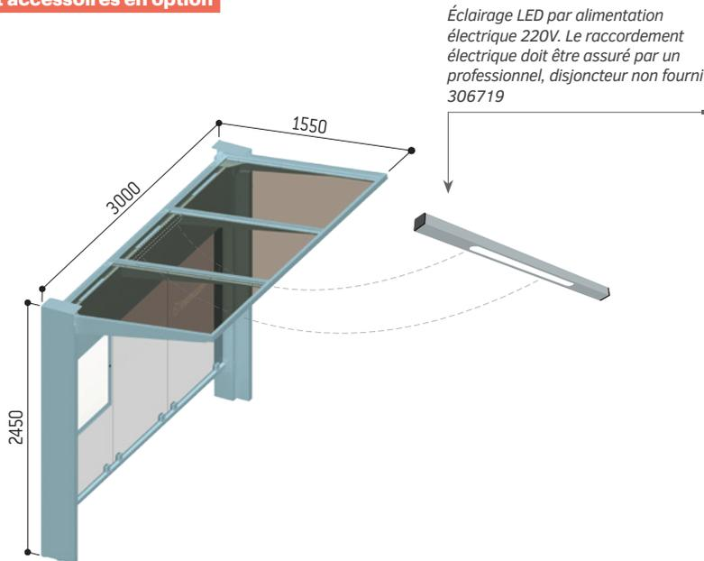
Éclairage LED par alimentation électrique 220V. Le raccordement électrique doit être assuré par un professionnel, disjoncteur non fourni 306719
